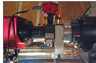
Un télescope Maksutov de 180 mm de diamètre à f/15 est monté en parallèle au T60. Instrument de guidage ou destiné à des études spécifiques (planètes, PHEMU...), il est équipé d'une caméra CCD ZWO ASI290MM, avec mise au point et roue à filtres motorisées. Des filtres L, R, V, B et méthane sont disponibles.
